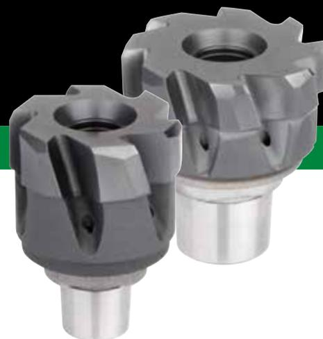
Обычно у развёрток подобного типа твёрдосплавные кромки напаиваются на каждый зуб стального корпуса. Новые же развёртки TRF и TRM обладают цельной твёрдосплавной напайной торцевой режущей частью в виде диска. Это позволило увеличить количество переточек и значительно уменьшить стоимость обработки отверстия. Новый сплав WU05PR™ позволяет выдерживать постоянный размер диаметра отверстий в 2 раза дольше по сравнению со сплавами традиционных развёрток.
