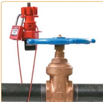
Использовать тросовое фиксирующее устройство для блокировки шиберных вентилялей
