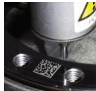
Маркировка детали 2D-кодом
