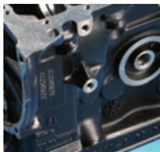
Маркировка блока цилиндров
